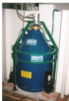
Figure 1 - A gauche : Gravimètre supraconducteur de l'observatoire gravimétrique de Starsbourg. Au centre : schéma de principe, lévitation de la sphère de masse m . A droite : allure de F(z)
